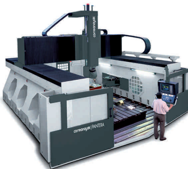
CORREATANAYAK. Fresadora gantry CNC, con mesas de 16 x 6 metros.
